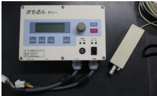
写真 結露センサー付き複合環境制御装置 (まもるんサリー)
