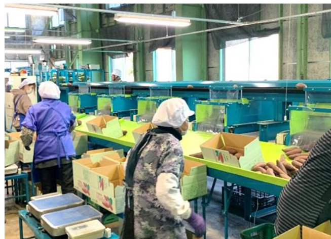
写真1 鍵盤式選果機による選果の様子
