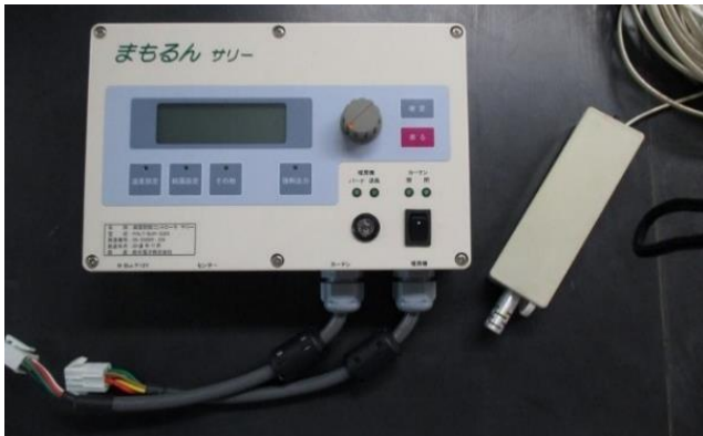
写真 結露センサー付き複合環境制御装置 （まもるんサリー/鈴木電子（株）製）
