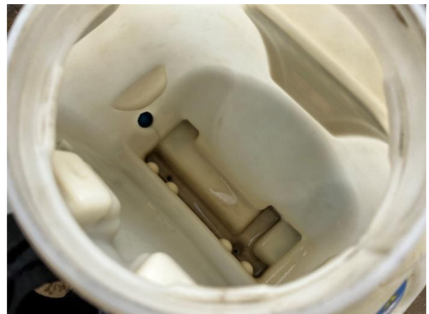
図：底に農薬が残らないよう、タンクを3回以上洗浄しましょう。
