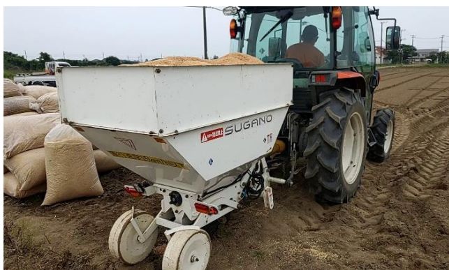
写真2 モミサブローによる施工
